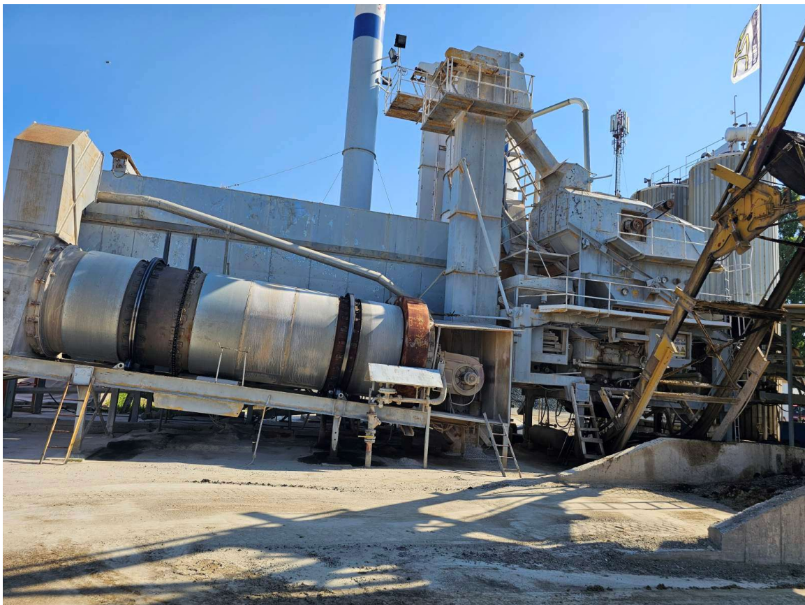
Slika 16. Asfaltna baza – sušara (Izvor: PZC BROD d.o.o., kolovoz 2025.)
