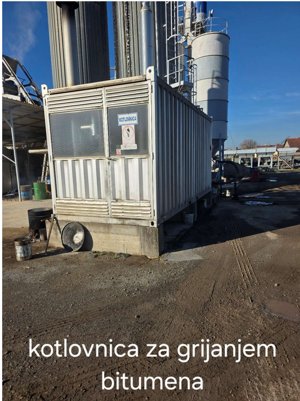
Slika 17. Asfaltna baza – kotlovnica za grijanje bitumena (Izvor: PZC BROD d.o.o., kolovoz 2025.)
